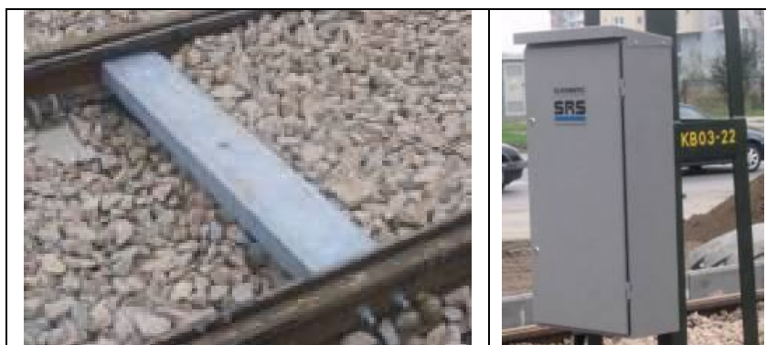
Rysunek nr 164. Przykład smarownicy torowej SRS oraz szafy z aparaturą sterowniczą smarownicy [Źródło: www.transportszynowy.pl ]
