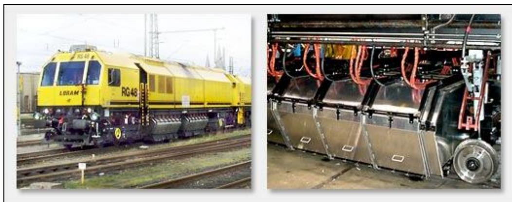
Rysunek nr 163. Widok maszyny do szlifowania szyn RG 48 I +II [Źródło: www.schweerbau.de/]
