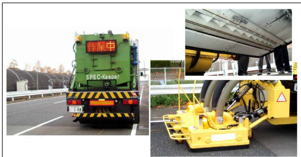
Rysunek nr 158. Sprzęt wykorzystywany przy oczyszczaniu nawierzchni z asfaltu porowatego [Źródło: Zastosowanie nowoczesnych technologii w konstrukcjach drogowych, Zakopane 15-17.09.2010 r.]
