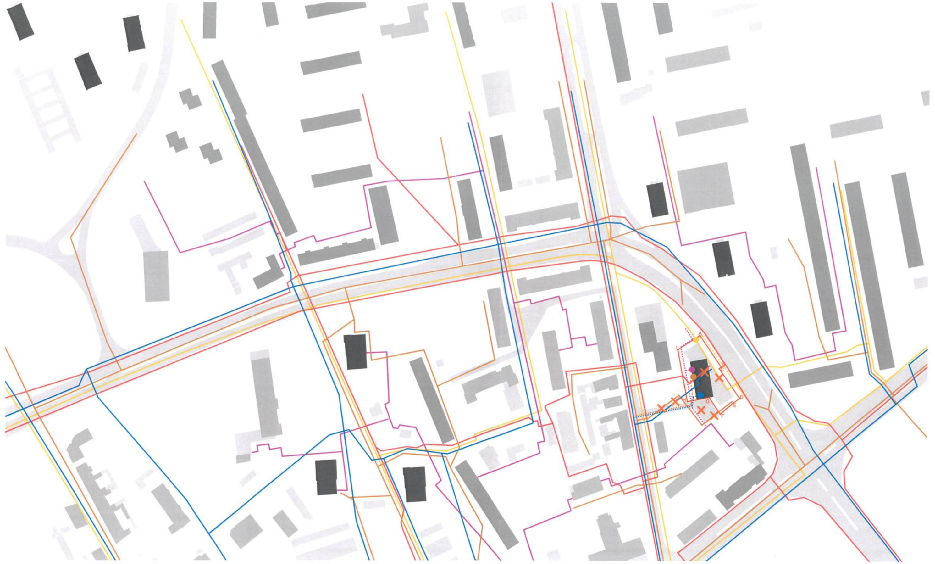
PLANSZA 3A - PRZEBIEG GŁÓWNYCH ELEMENTÓW SIECI UZBROJENIA TERENU NIEZBĘDNYCH DLA OBSŁUGI PROPONOWANEJ ZABUDOWY I ZAGOSPODAROWANIA TERENU
