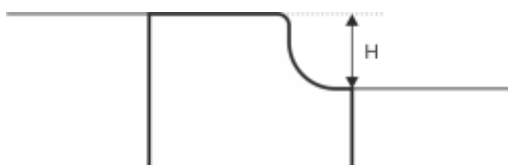
Rys. 7. Przekrój przykładowego systemowego krawężnika przystankowego
