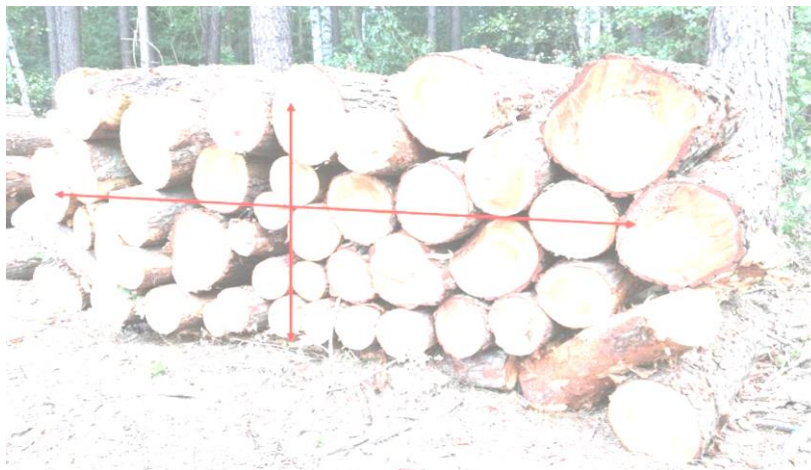
Ryc. 6. Pomiar przeciętnej szerokości i wysokości w stosie S4
