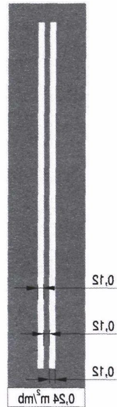
Linia P-4 „Linia podwójnie ciągła”
