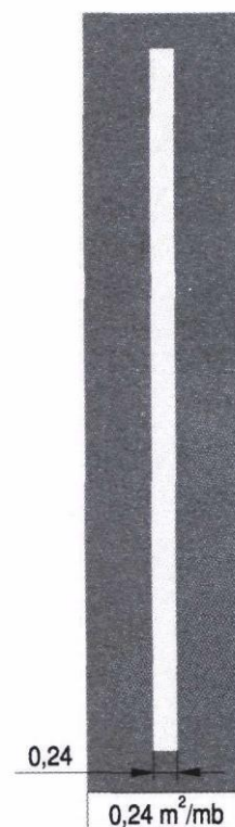
Linia P-7b „Linia krawędziowa ciągła szeroka”
