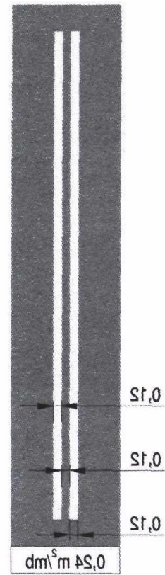
Linia P-4 „Linia podwójnie ciągła”
