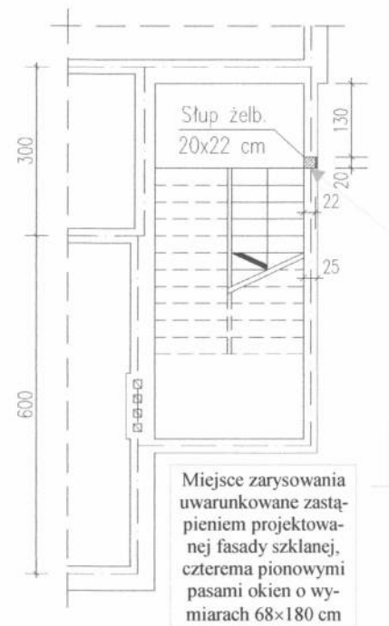
Rys. 3.2. Miejsce zarysowania styku ściany klatki schodowej z żelbetowym słupem
