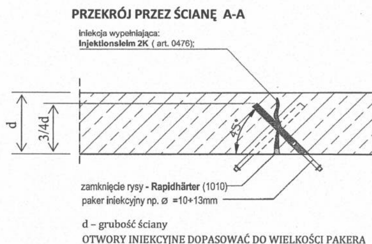
Rys. 5.4. Iniekcja wypełniająca poziomego rozwarstwienia ścian północnej części budynku sali sportowej, sposób rozmieszczenia pakarów
